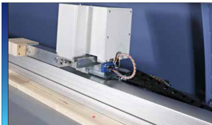
Dettaglio dello spintore con sensore di misurazione pezzo Detail of the pusher with measuring sensor Detalle del empujador con sensor de medición pieza
